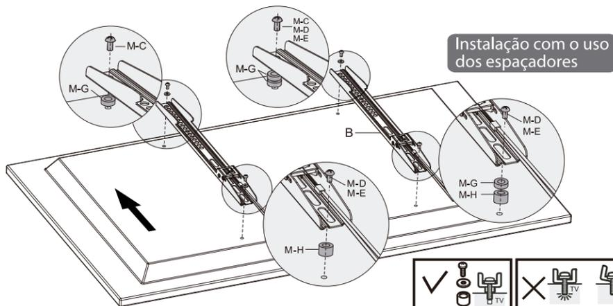
Instalação com o uso dos espaçadores
