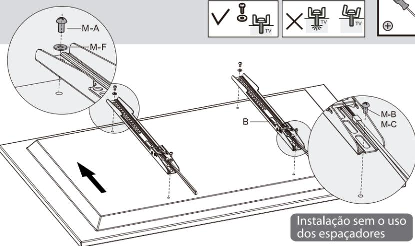
Instalação sem o uso dos espaçadores
